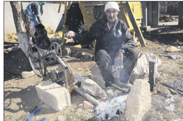
Das Schmiedefeuher wird mit einem, zum Gebläse umgebauten, Fahrrad angetrieben.
